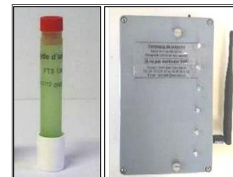
Figure 177 : Tubes passifs et micro-capteur laser
