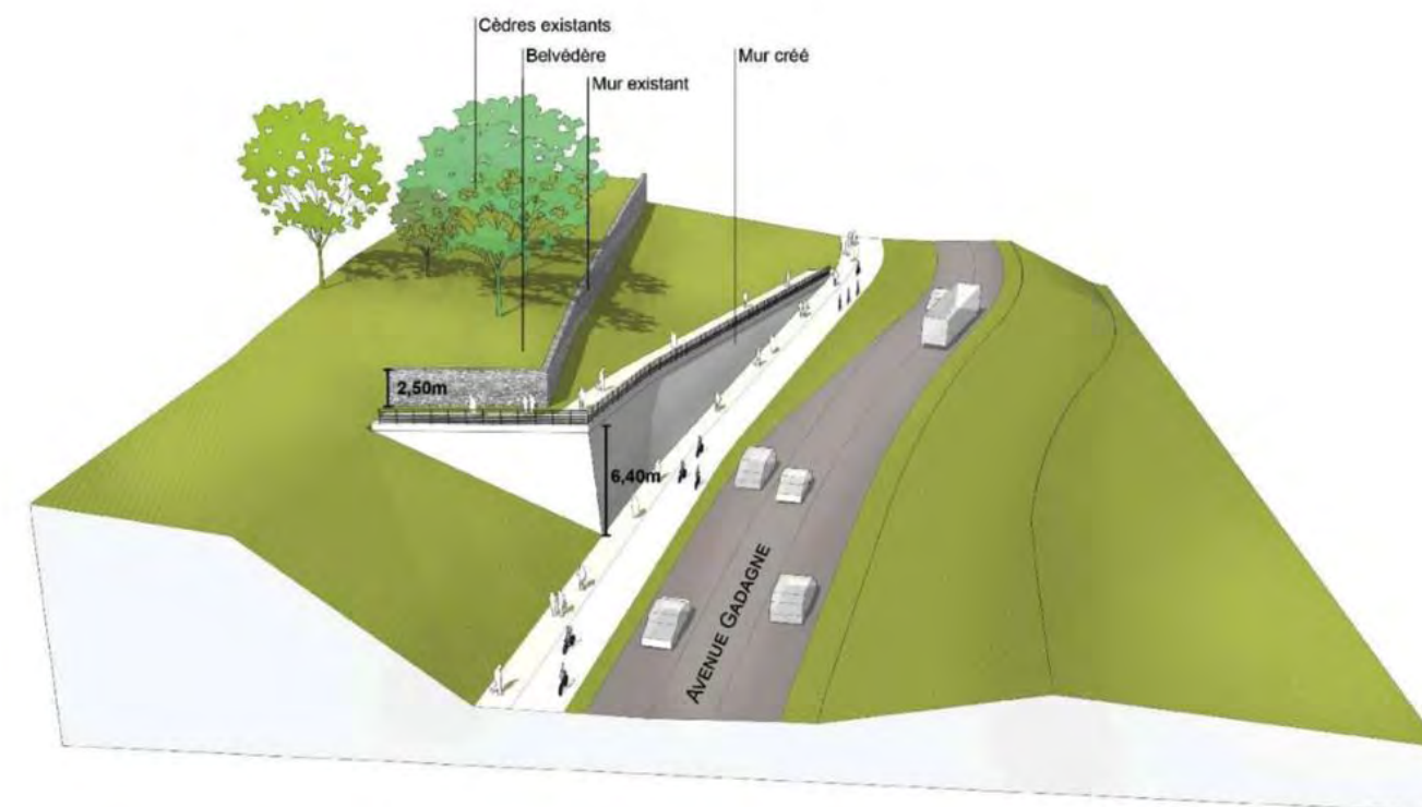
Parti pris d'insertion de la voie nouvelle avec la conservation du mur en pierre existant (source : AVP du groupement Arcadis)
