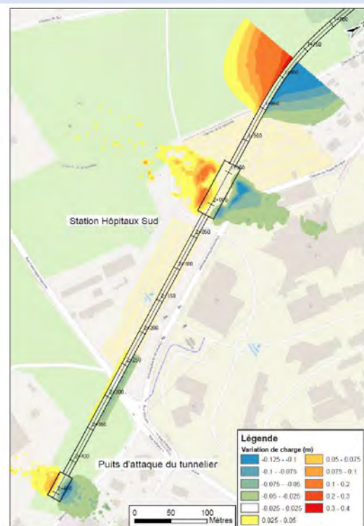
Variation de charge sur le tronçon du métro allant du PK 1770 au PK 2500 après implantation des structures souterraines (Source : Evaluation du risque d'effet Barrage)
