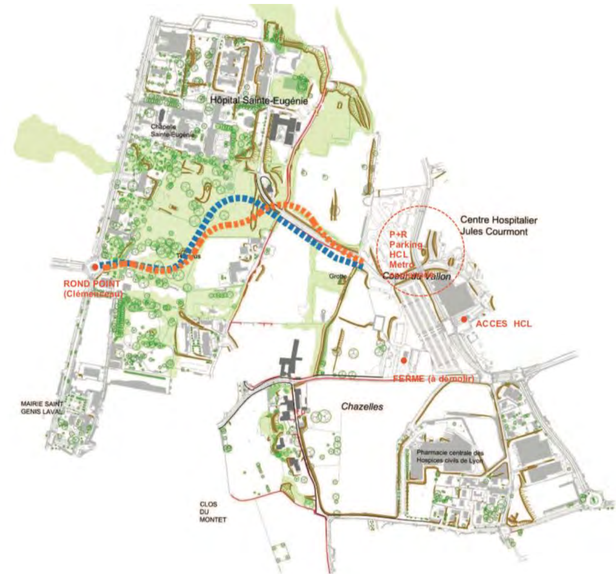
Superposition des deux solutions de tracé étudiées – le tracé retenu est en orange (source : AVP du groupement Arcadis)
