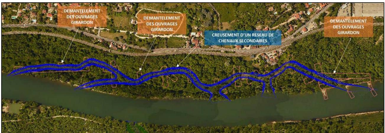
Figure 31 : Vue en plan illustrant les travaux prévus sur le site d'Irigny
