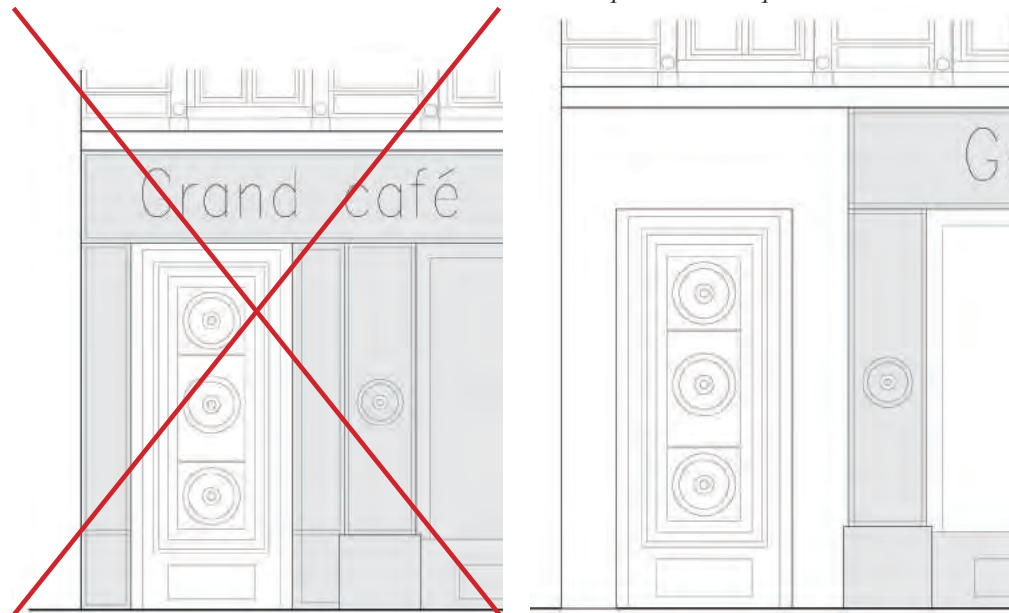
La devanture en applique doit respecter les éléments de modénature de la façade. Porte, corniche, éléments de décor, doivent être autonomes et apparents.
