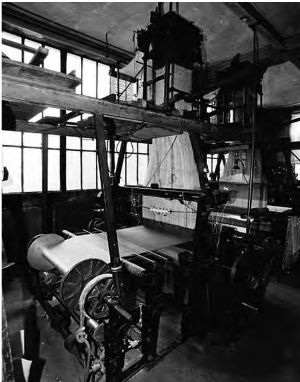
Métier à tisser jacquard, petit battant, à mécanique Verdol, fabrication Diederich. patrimoinerhônealpes.fr
