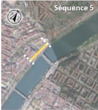
La variante 1-B propose une piste cyclable à double-sens dans la trémie la plus proche du Rhône, sur l'emprise de la piste cyclable actuelle trop étroite pour que les vélos y circulent à double-sens et d'une des voies de circulation, tout en maintenant le trottoir existant pour conserver la traversée des piétons.
