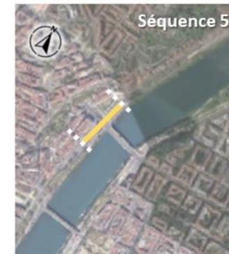
La variante 1-A consiste en une piste cyclable à double-sens passant au niveau du pont. La sécurisation de la traversée des cycles impose l'ajout d'une ligne de feux trop proche de la sortie du tunnel pour respecter la réglementation de sécurité incendie des tunnels.
