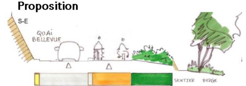
À noter également qu'en fonction de la variante retenue sur le cours d'Herbouville, la largeur de la piste cyclable pourrait être réduite (réduction à 2 m au droit de la rampe de liaison vers le carrefour de la boucle selon le scénario retenu sur le cours d'Herbouville).
