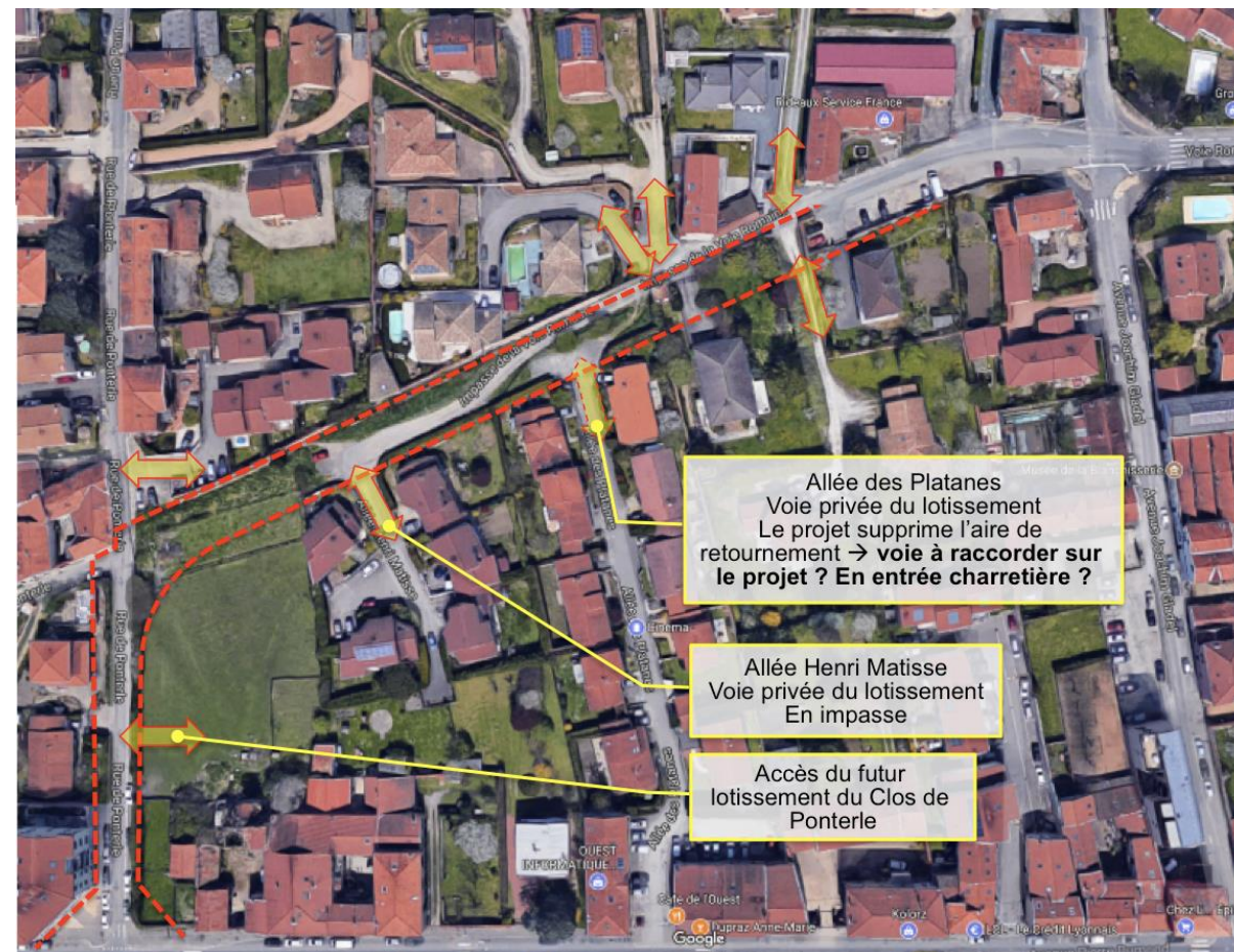
Figure 51 : Rétablissement des accès riverains
