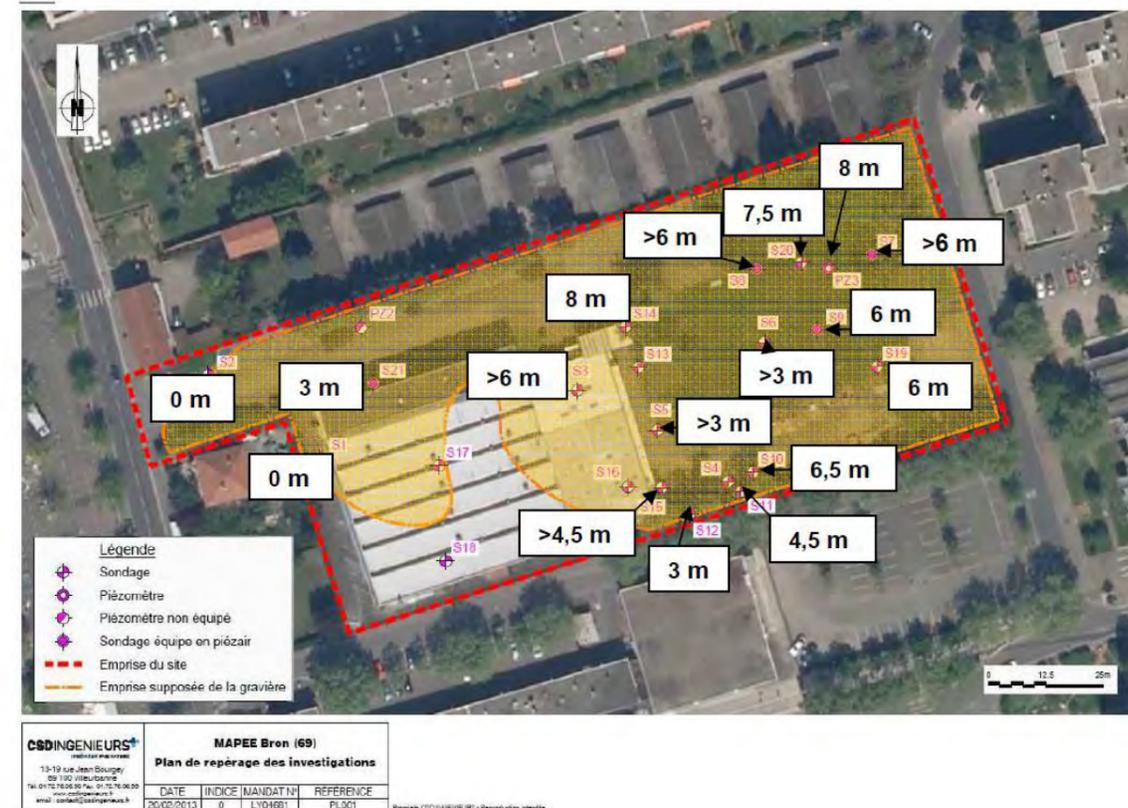
**Figure 86 : Emprise supposée de la gravière et épaisseur des remblais**
