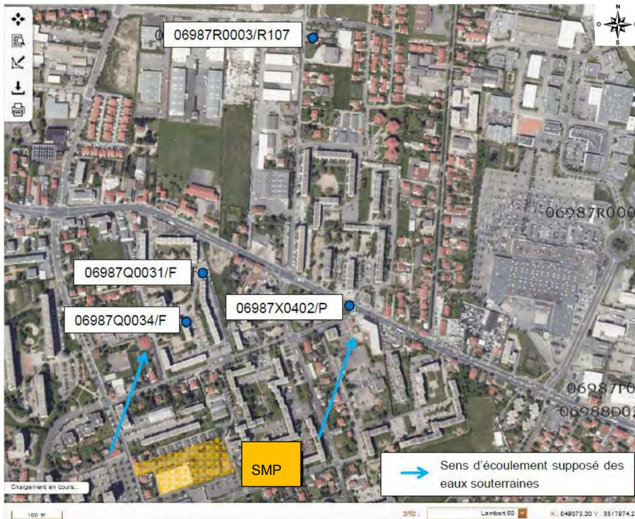
Figure 98 : Sens d'écoulement supposé des eaux souterraines au droit du site
