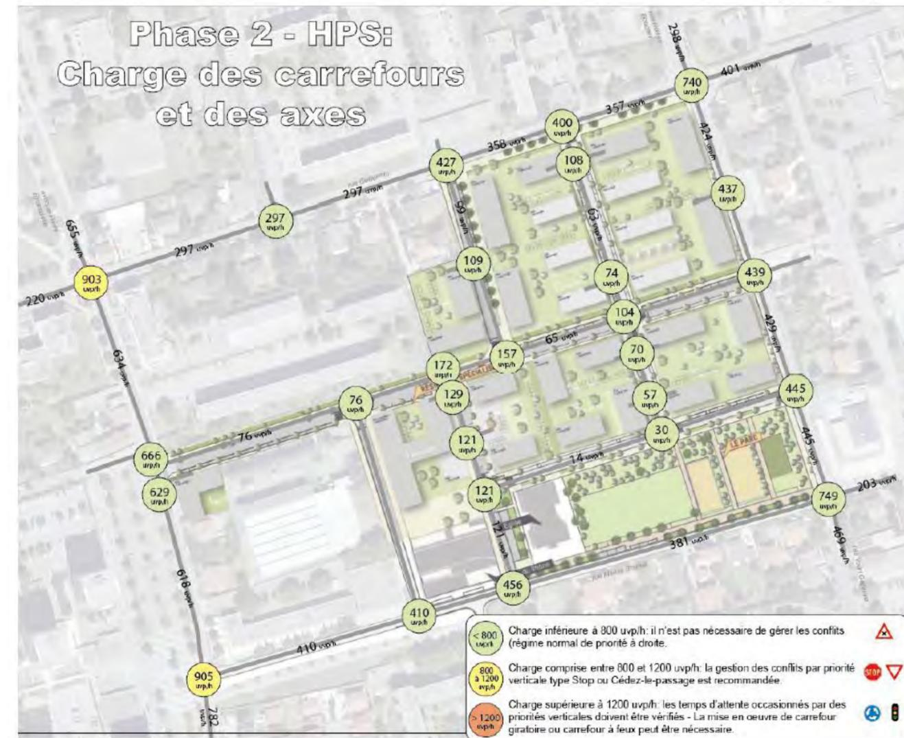
Figure 190 : Charges de trafic des axes et carrefours en HPS
