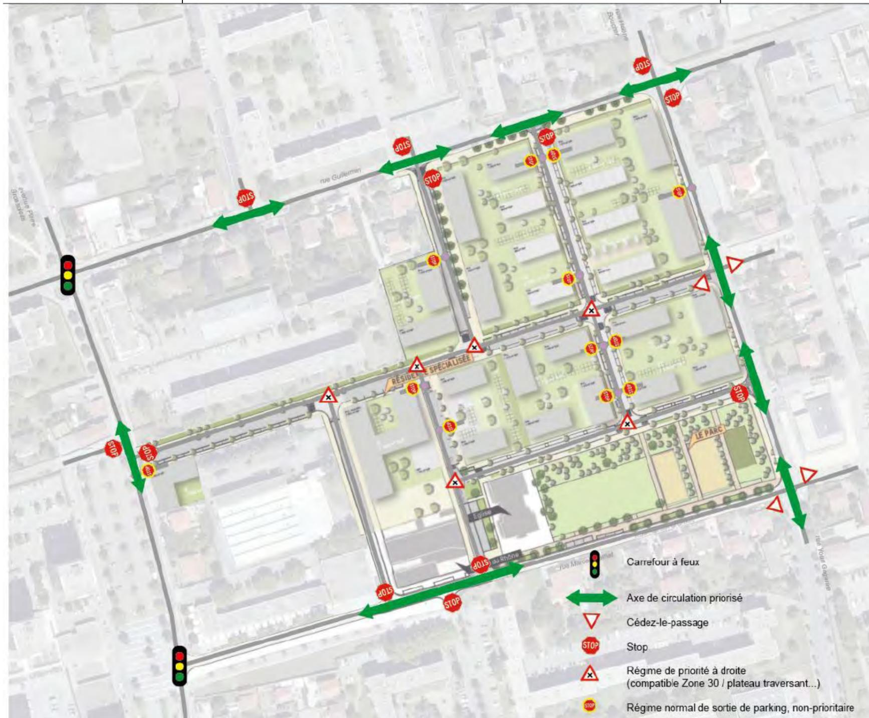
Figure 191 : principe de gestion des différentes intersections du projet de ZAC Bron- Terrailon.
