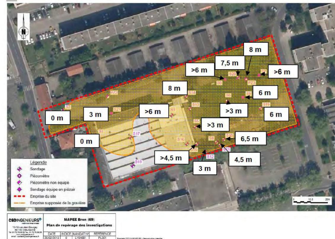
Figure 8 : Emprise supposée de la gravière et épaisseur des remblais
