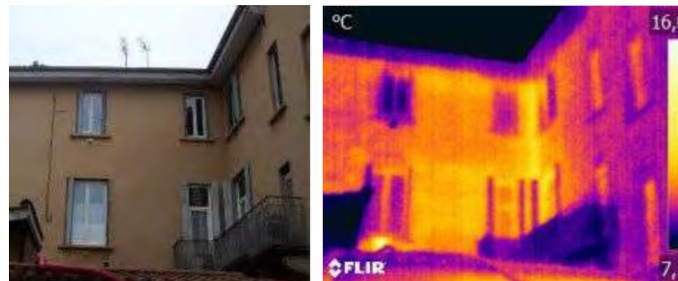
*Déperditions filmées à l'aide d'une caméra thermique.*
