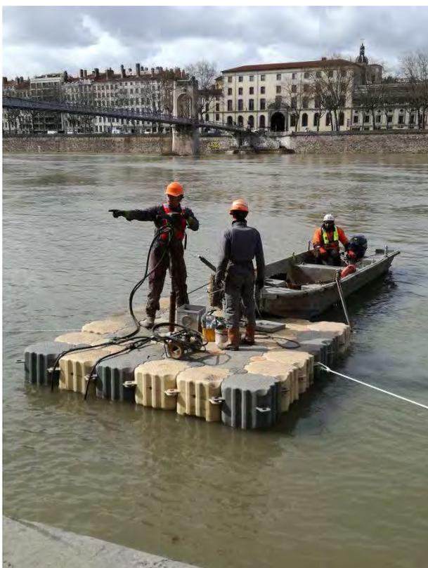
Prélèvement au point C (enfoncement du carottier)
