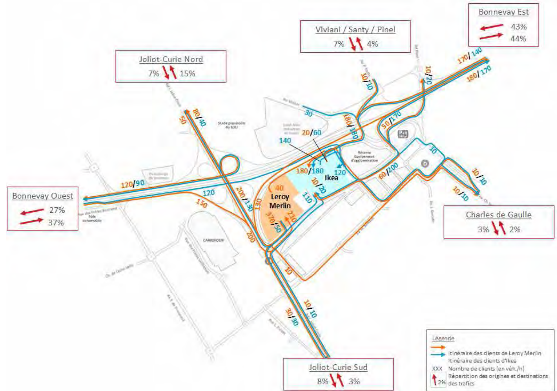
Itinéraires des clients d'IKEA et de Leroy Merlin à l'heure de pointe du soir de semaine (vendredi)
