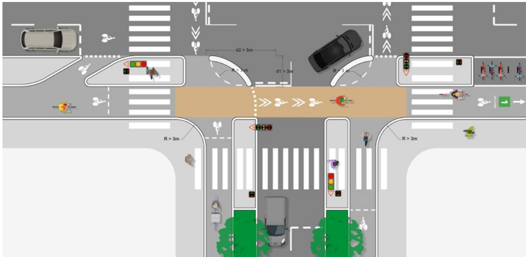
Préconisation de traitement d'une intersection régulée par feux dans le cas de deux pistes unidirectionnelles
