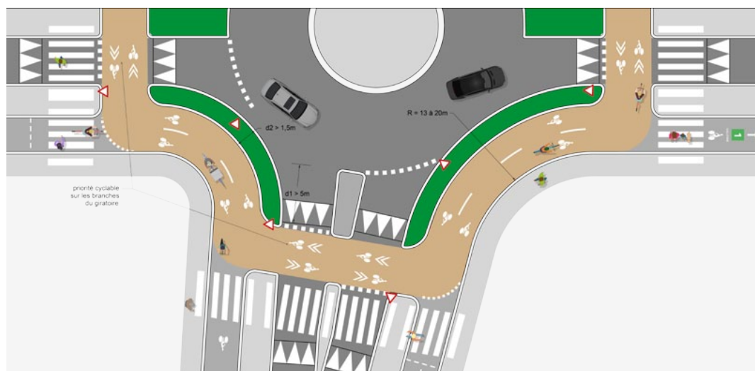
Préconisation de traitement d'un giratoire compact dans le cas d'une piste bidirectionnelle
