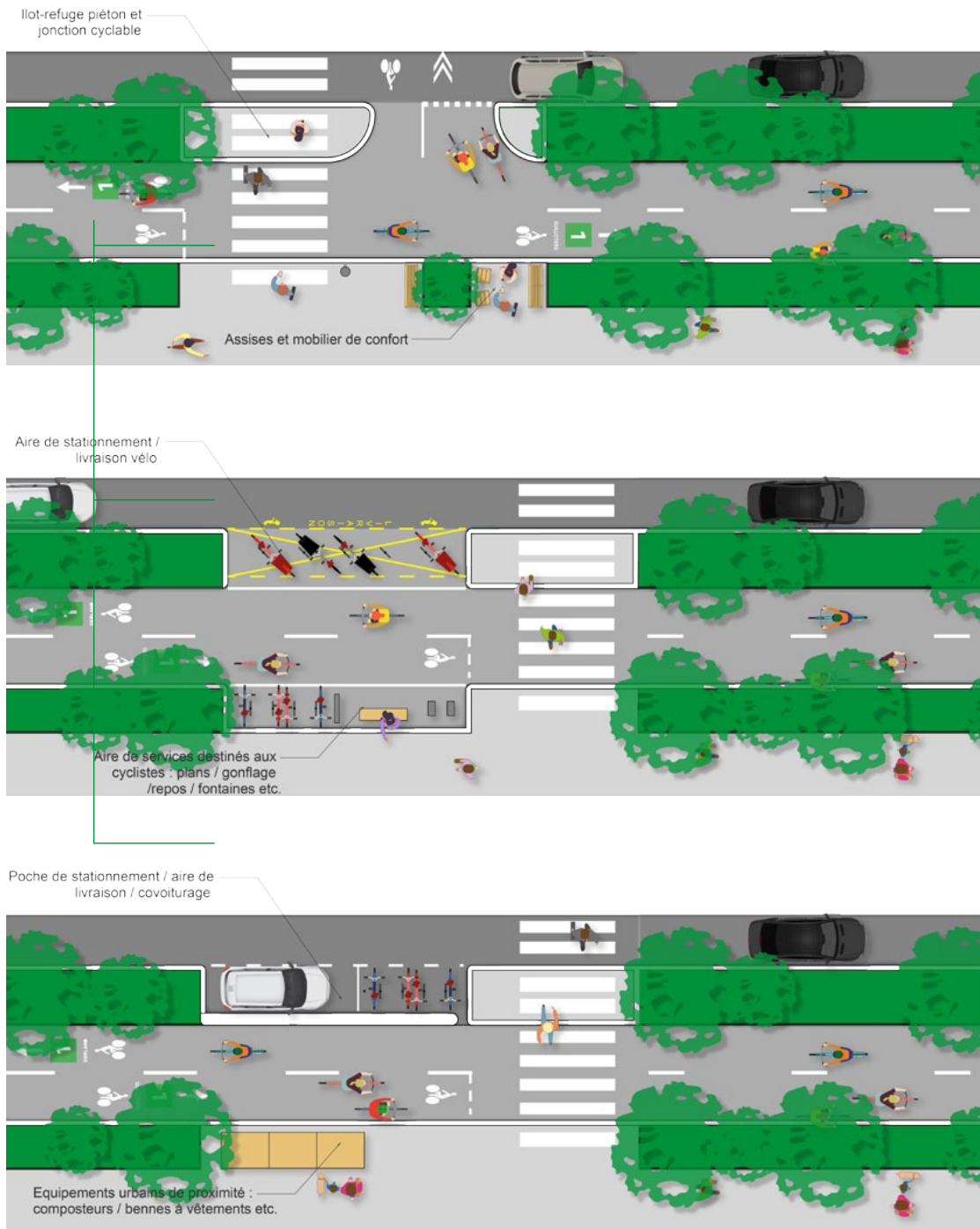
Exemples d'intégration de fonctionnalités associées aux Voies Lyonnaises dans la largeur des bandes plantées
