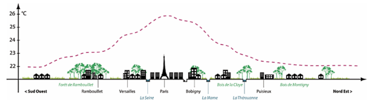
Figure 124 : Coupe schématique de visualisation des températures en 2008 pour une nuit de canicule (type été 2003)
