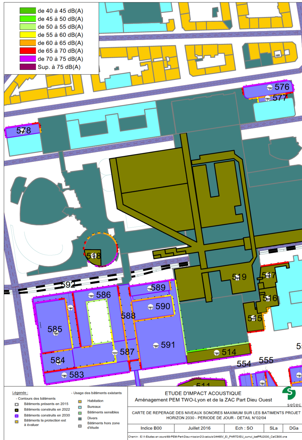
Niveaux sonores maximums en façades des bâtiments créés / JOUR, horizon 2030 / CENTRE COMMERCIAL
