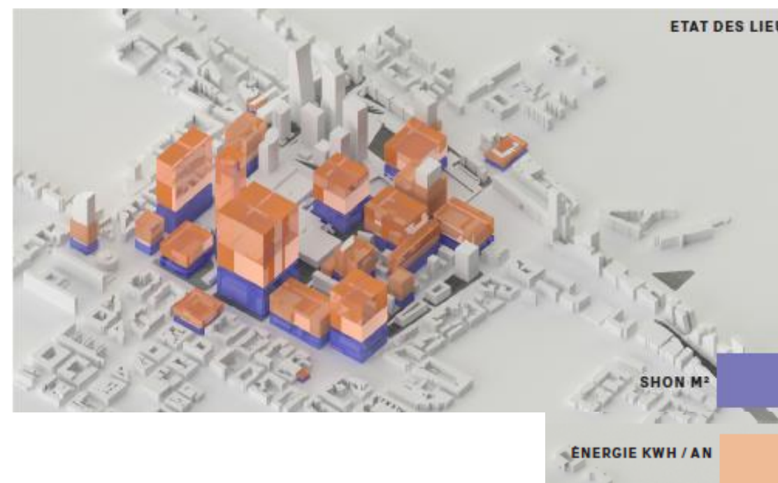
Figure 97 : Maquette des consommations énergétiques et des surfaces (Source : Plan de Référence V2, annexe Cahier « Part Dieu durable : les systèmes »)
