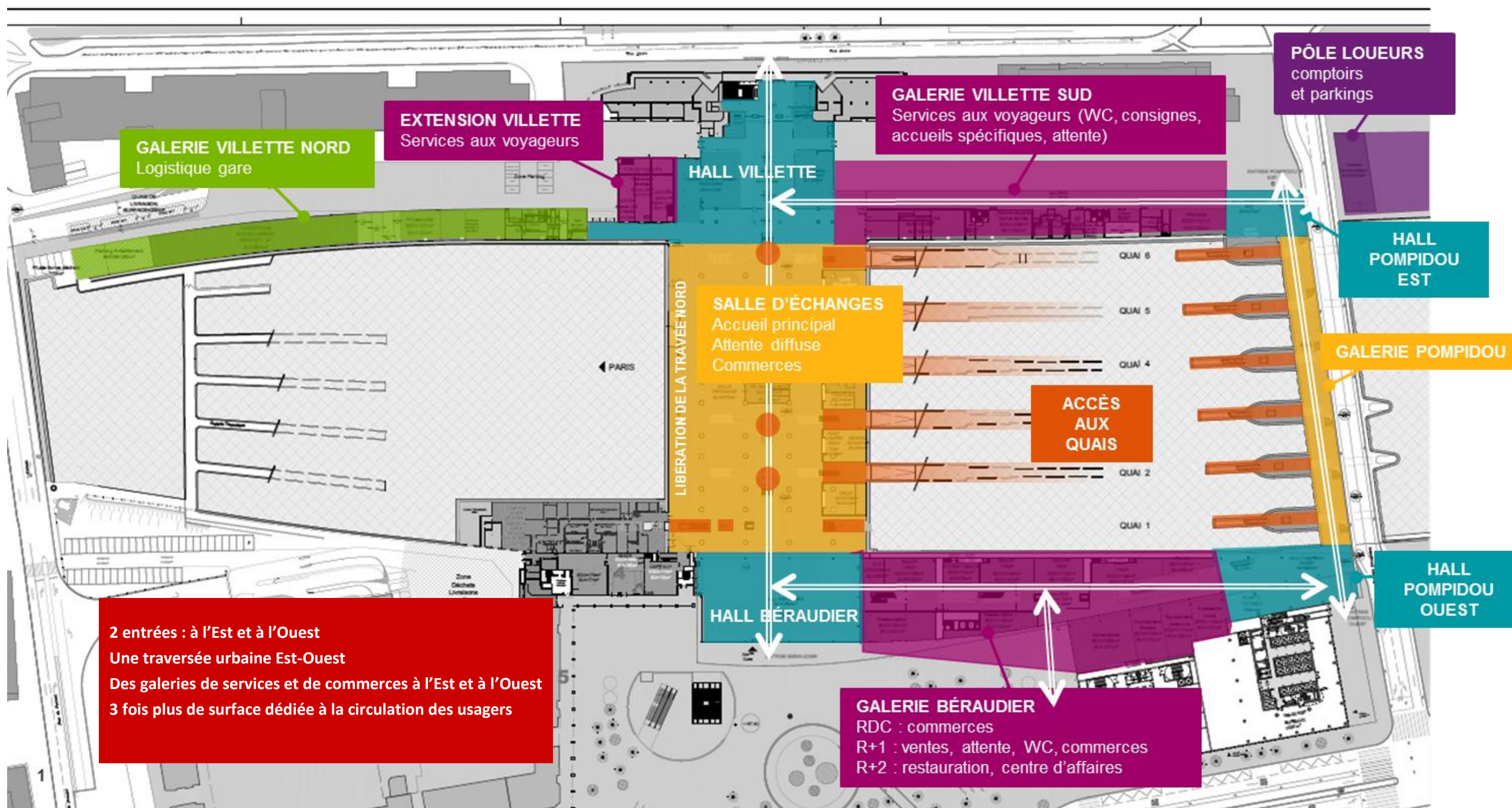
Figure 16 : Organisation projetée de la gare (Source : Gares et Connexions, Présentation du projet, mai 2016)
