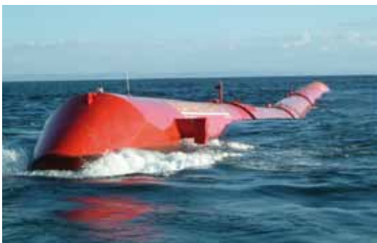
Système « Pélamis » exploitant l'énergie des vagues Source : Pelamis Wave Power Ltd)
