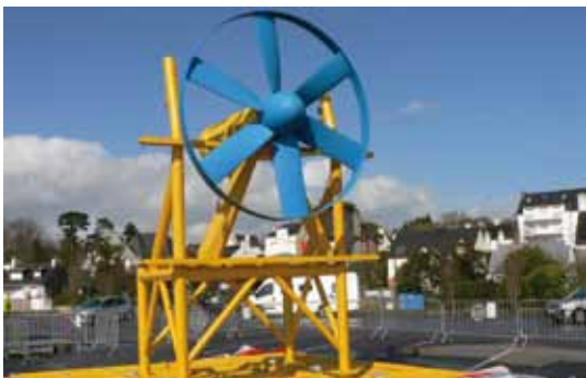
Hydrolienne pilote « Sabella » installée en 2008 dans l'estuaire de l'Odet (Finistère) - Source : Sté HYDROHELIX ENERGIES
