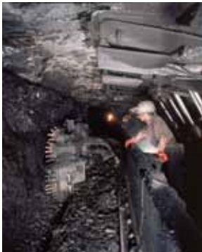
L'excavation du charbon : abattage par rabot à Courrières (Pas de Calais) - Source : Charbonnages de France
