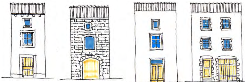
Compositions locales, régulières, très simples : baies superposées de taille décroissante, faible nombre de travées (une ou deux travées).
